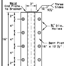
**8 GUARDRAIL ANCHOR BRACKET**
