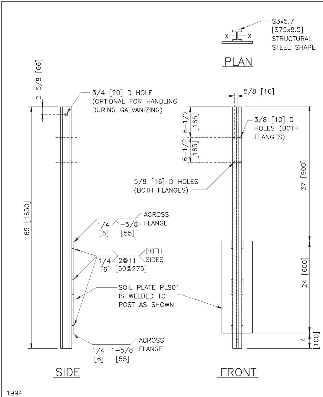
WEAK POST GUARDRAIL POST & WELDED SOIL PLATE
