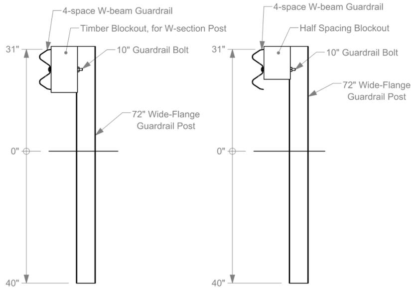
**Figure 5.10. Blockout Comparison.**
